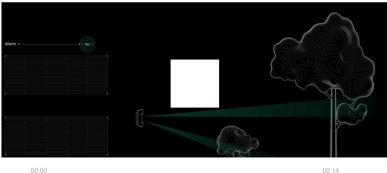
MotionCam Outdoor dispose de deux capteurs IR indépendants, dont les signaux sont analysés par un algorithme LISA en deux étapes. Dès que les deux capteurs IR détectent un mouvement, LISA effectue une corrélation et une analyse spectrale des signaux, ce qui vous permet de distinguer instantanément les menaces réelles des interférences.
