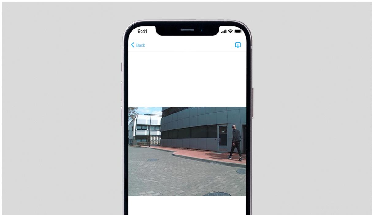
Lorsque le détecteur est déclenché, l'appareil photo intégré de MotionCam Outdoor peut prendre 1 à 5 images avec une résolution de 320 × 176 et jusqu'à 3 images avec une résolution de 640 × 352 pixels. Le détecteur dispose d'un éclairage infrarouge pour les prises de vue dans l'obscurité, qui n'est activé que lorsqu'une alarme est déclenchée.
