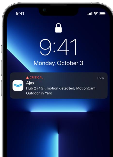
Les utilisateurs savent exactement où le mouvement est détecté. Les notifications contiennent le nom de la centrale (nom de l'objet surveillé), le nom de l'appareil et la pièce virtuelle à laquelle le détecteur est affecté.
