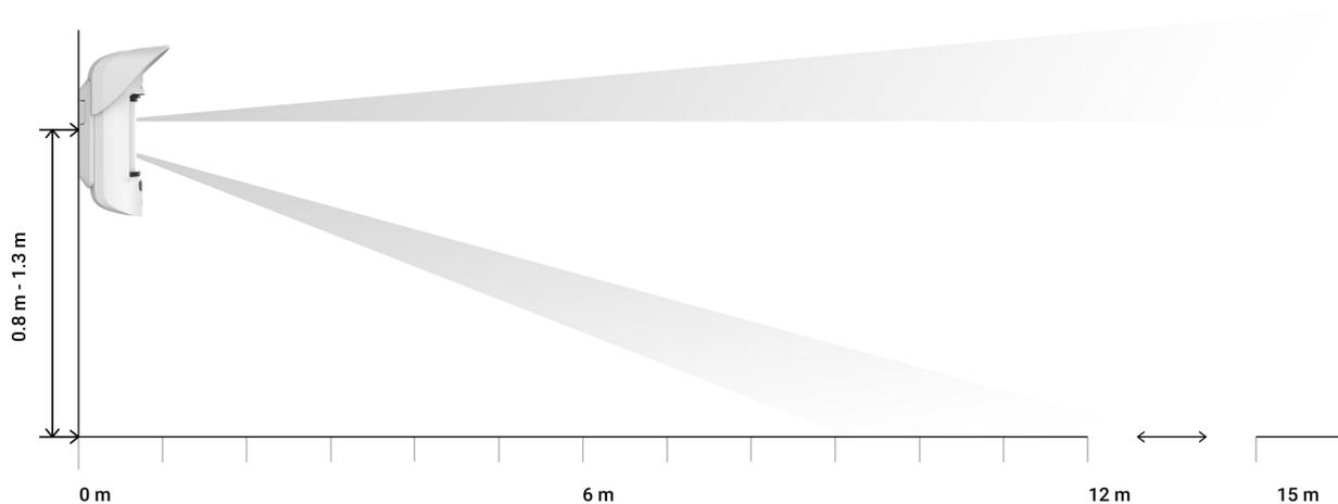
La distance de détection est réglée à l'aide de la glissière **Distance de détection (Detection Distance)** située sur le panneau arrière du détecteur. Lors du choix du lieu d'installation, tenez compte de la portée maximale de détection du détecteur. Il dépend de la sensibilité, de la position de la glissière Distance de Détection, du type et de la vitesse du mouvement de la personne (course, marche) et de la température ambiante.
